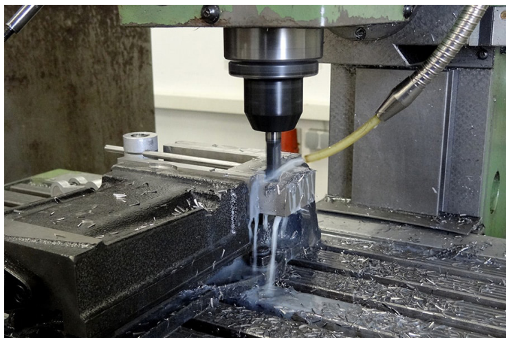
Рисунок 1 – Процесс сверления с применением СОЖ
