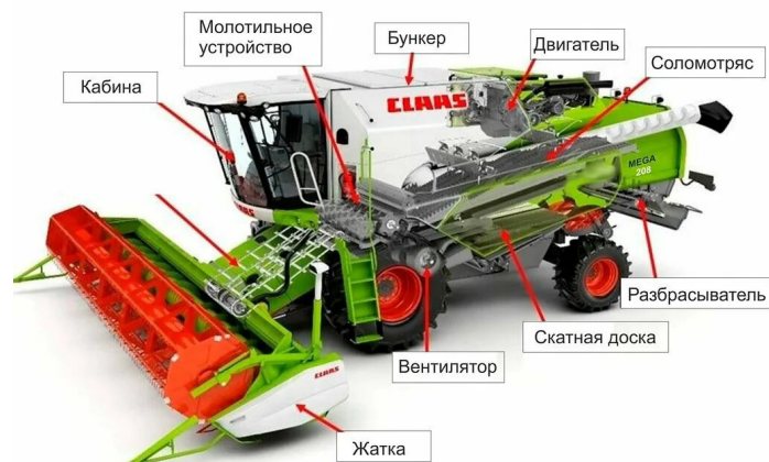
Рисунок 1 – Основные механизмы комбайна
